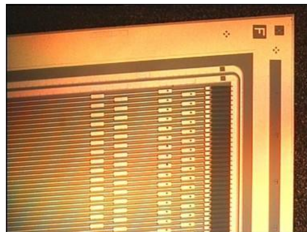
Detail senzoru pro diskový modul
