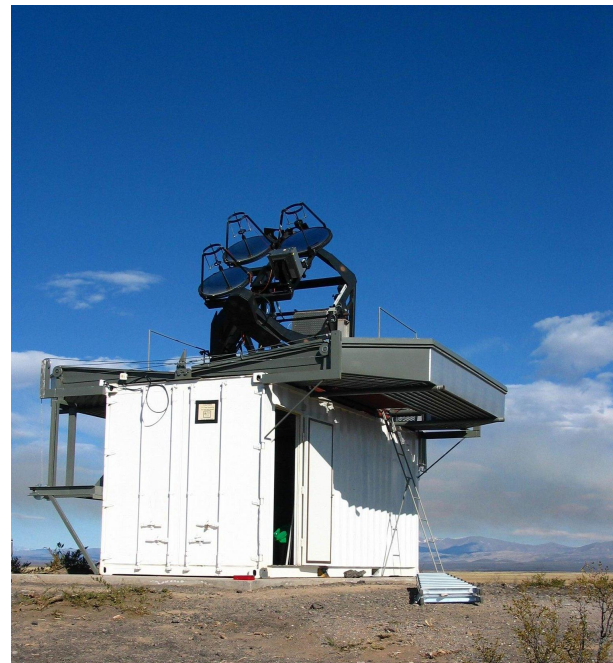
Obr. 6: Lidar na observatoři Pierre Auger.
