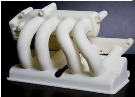
a) schéma laserového systému pro SLS, b) postup střídavého nanášení vrstev, c) průmyslový SLS systém sPro 230, d) pouzdro a držák diferenciálu přední osy – srovnání dvoudílného tvářeného a monolitického sintrovaného výrobku, e) model rozdělovač motoru, f) 3D model dětské sedačky
