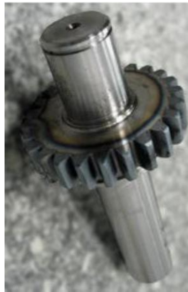
d) schéma laserového kalení obdélníkovým homogenním svazkem, e) zakalené ozubení kola, f) zakalené ohraničení výlisku v licí formě pro plastové díly Audi, g) zakalené hrany ohýbacích nástrojů ( http://www.matexpm.com/cs/mediainfo - názorná videa)
