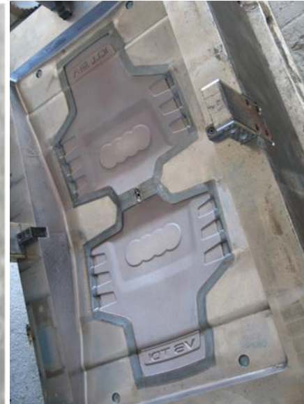
d) schéma laserového kalení obdélníkovým homogenním svazkem, e) zakalené ozubení kola, f) zakalené ohraničení výlisku v licí formě pro plastové díly Audi, g) zakalené hrany ohýbacích nástrojů ( http://www.matexpm.com/cs/mediainfo - názorná videa)
