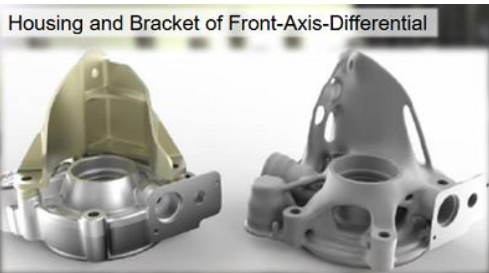
a) schéma laserového systému pro SLS, b) postup střídavého nanášení vrstev, c) průmyslový SLS systém sPro 230, d) pouzdro a držák diferenciálu přední osy – srovnání dvoudílného tvářeného a monolitického sintrovaného výrobku, e) model rozdělovač motoru, f) 3D model dětské sedačky
